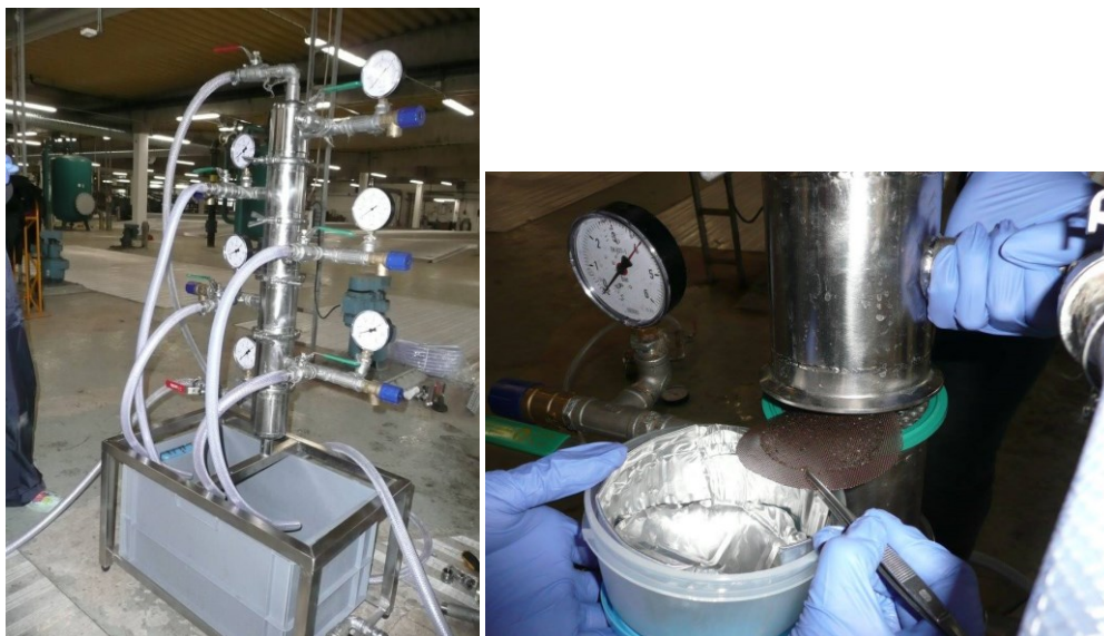
Figur 6. Foto af filtertårn og udtagning af ét af stålfilterne fra tårnet.
